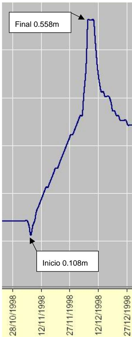
Fig. 1. – Detalle de la subida de niveles en el lago durante la Perelloná.
